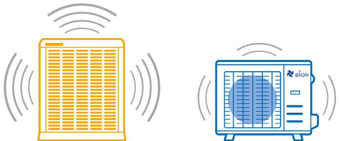
Système central traditionnel : 73 dB(A) Système Central-Elios : 65 dB(A)
